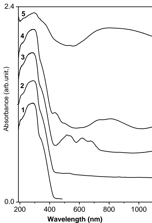
Fig. 3 – Electronic DR spectra of the (1)L, (2)[Mn(L) 2 ] \cdot 2H 2 O, (3)[Co(L) 2 ] \cdot 2H 2 O, (4)[Ni(L) 2 ] \cdot 2H 2 O and (5)[Cu(L) 2 ] \cdot 2H 2 O.
